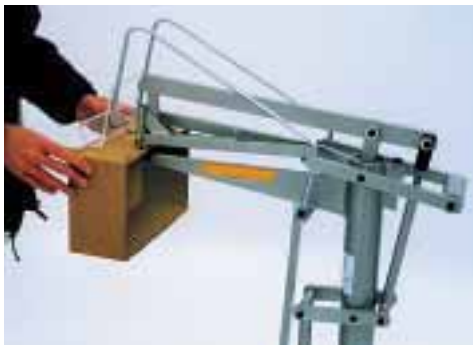
ST Q 270 D Doppelkopf. Heftabstand 70 mm. Zwei Heftungen gleichzeitig.
