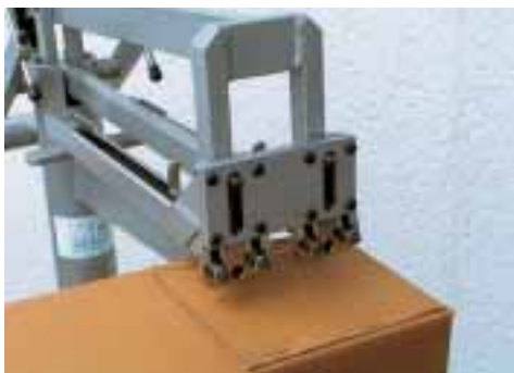
ST Q 270 D Doppelkopf. Heftabstand 70 mm. Zwei Heftungen gleichzeitig.
